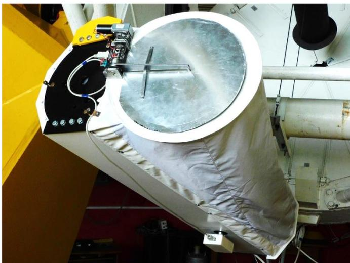
Рис. 2.3.1.5.1. Зеркальный Райт со светозащитным тентом и крышкой
