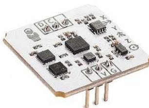
Рис.10. IMU-сенсор на 10 степеней свободы.
