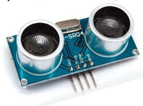
Рис.9. Ультразвуковой дальномер модели HC-SR04
