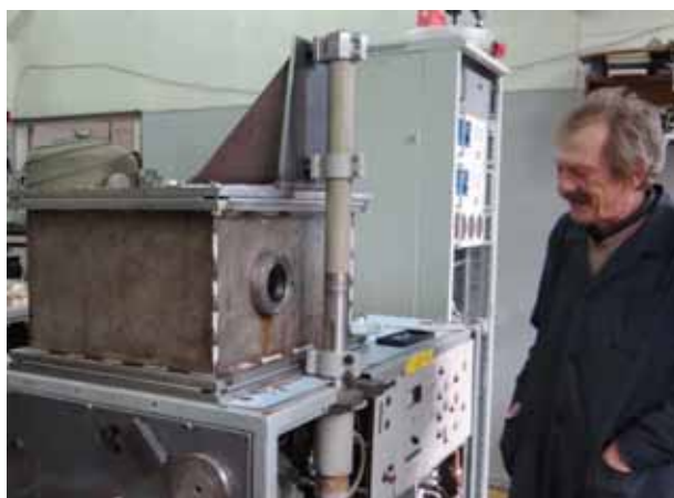
Рисунок 5.7 – Установка для изготовления монохроматических фильтров.
