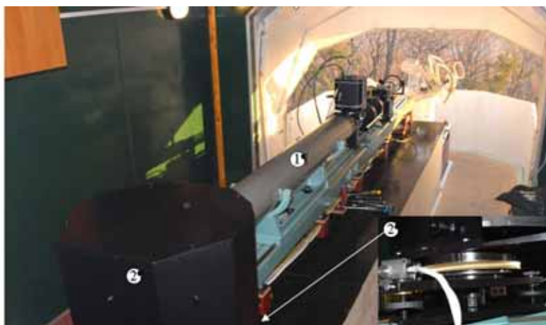
Рисунок 5.11– Узел автоколлиматора спектрографа -1, узел дифракционной решетки – 2.
