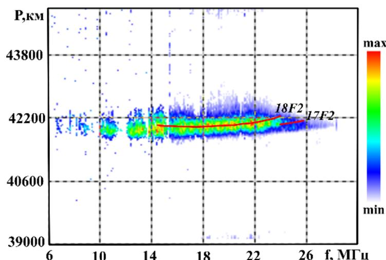
Рис. 2.2.2.1.2. Ионограмма НЗ на кругосветной трассе и результаты моделирования и интерпретации (красная линия) модов распространения 17F2 и 18F2 (число отражений траектории распространения сигнала от F2-слоя ионосферы)
