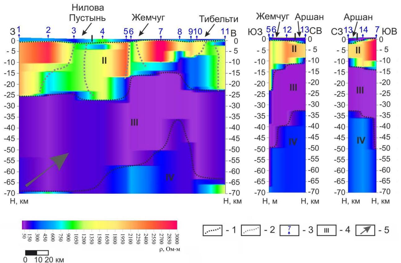
Рис. 2.2.4.1.1. Геоэлектрические разрезы по данным МТЗ: 1 — границы основных геоэлектрических слоев; 2 — границы зон, ассоциируемых с каналами флюидомиграции; 3 — физические наблюдения МТЗ и их номера; 4 — геоэлектрические слои; 5 — направление разогревающего воздействия от верхнемантийного плюма
