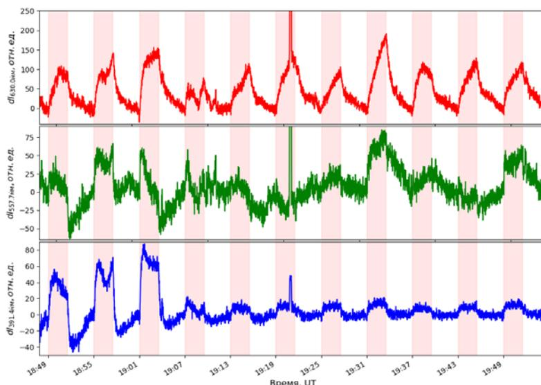
Рис. 2.2.4.12.1. Первое наблюдение в экспериментах на нагревном стенде СУРА эмиссии 391.4 нм (нижняя панель) с помощью трехканального фотометра 11.08.2023
