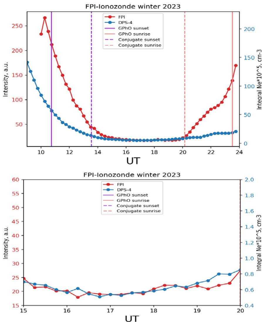
Рис 1.2.2.1. Сопоставление интенсивности линии 630 нм по данным ИФП (красная линия) и электронной концентрации по данным DPS-4 (синяя линия). Вертикальные линии показывают время локального (сплошные линии) и магнитосопряженного (штриховые линии) заката/рассвета на высоте 250 км
