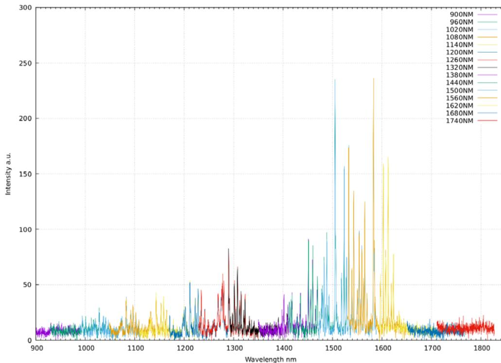
Рис 1.2.3.1. Совмещенные ИК-спектры при заданных положениях дифракционной решетки (отображены цветом).
