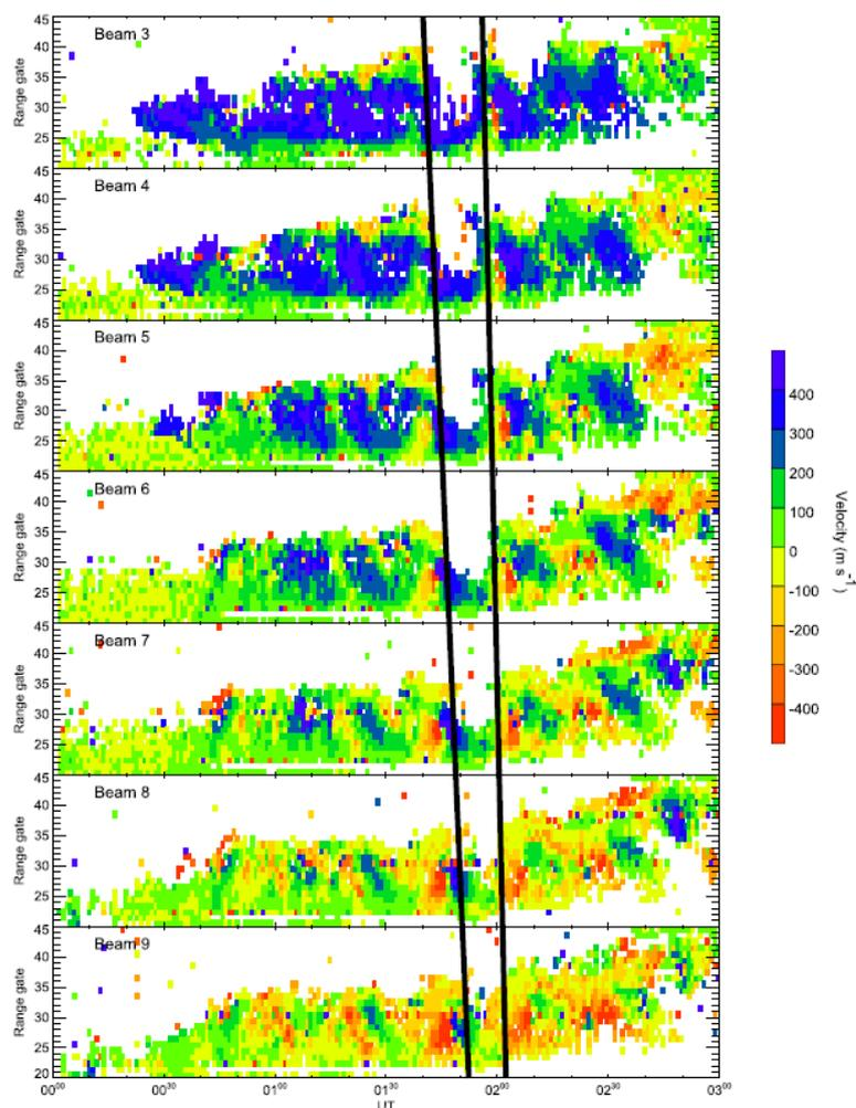
Рис. 2.2.5.3.1. Скорость вдоль лучей 3–9 радара SuperDARN HAN. Черными линиями отмечена перемещающаяся область потери высокочастотного сигнала
