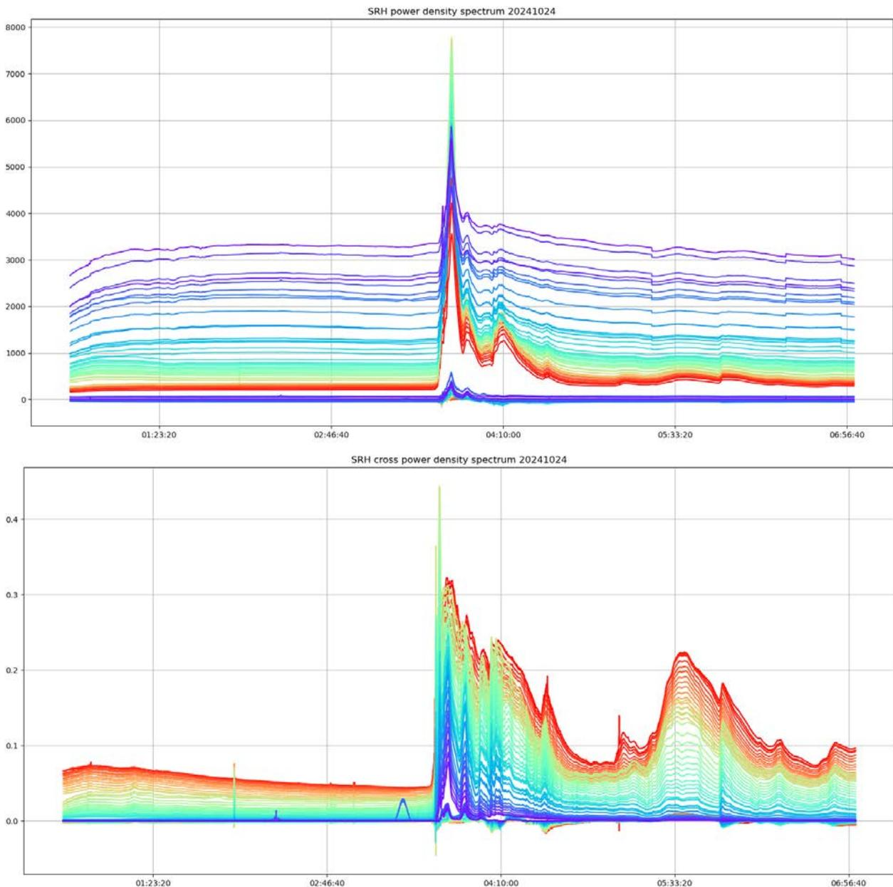
Рис. 3.9.1.2. — интегральный поток (верхняя панель) и корреляционные кривые (нижняя панель) Радиогелиографа 3–24 ГГц от 24.10.2024. Красный цвет — нижняя частота 2.8 ГГц, синий — 24 ГГц.
