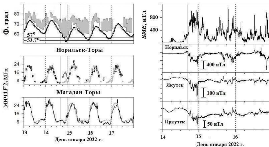
Рис. 2.2.2.3.1. Изменения исправленной геомагнитной широты аврорального овала (серая фигура) и дна ГИП на долготах 105° и 120° Е (линии), а также МНЧ1F2 на трассах Норильск–Торы и Магадан–Торы (слева); вариации SME-индекса и H-компоненты геомагнитного поля (справа). На левой верхней панели горизонтальными линиями отмечены широты средних точек радиотрасс
