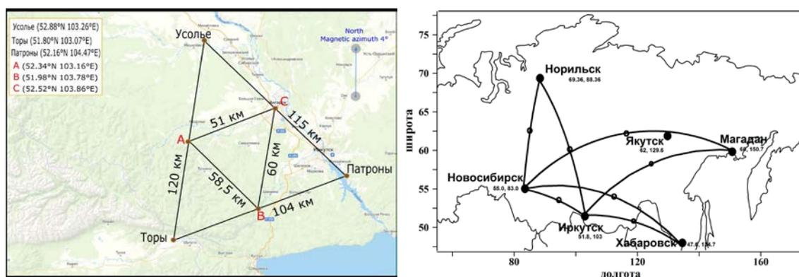
Рис. 2.2.2.5.1. Трассы слабонаклонного зондирования ионосферы в окрестности г. Иркутска (слева) и трассы наклонного зондирования в Азиатском регионе России (справа)
