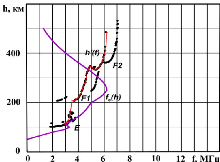
Рис. 2.2.2.1.1. Ионограмма вертикального зондирования (черные точки) и результаты моделирования высотно-частотной характеристики  $h'(f)$  (красная линия) по профилю плазменной частоты  $f_e(h)$  (бордовая линия)
