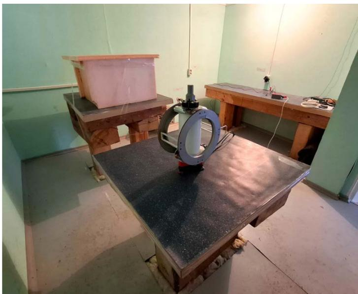
Рис. 3.7.2. Скалярно-векторный магнитометр POS-4 в вариационном павильоне КМИС
