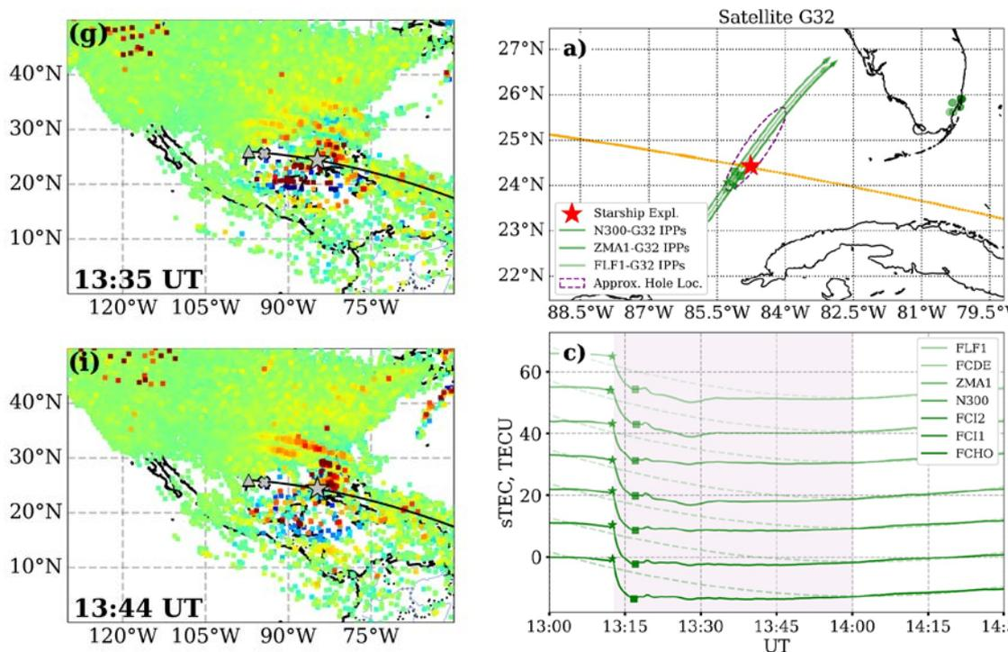
Рис. 2.2.1.1.1. Ионосферные возмущения во время пролета и взрыва космического корабля Starship 18 ноября 2023 г. в 13:35 и 13:44 UT (левые панели); положения станций ГНСС, их траектории для спутников G32 и вариации наклонного ПЭС. Пунктирный овал — пространственное положение области понижения ПЭС, красные звездочки — место взрыва Starship; серая область отмечает снижение ПЭС
