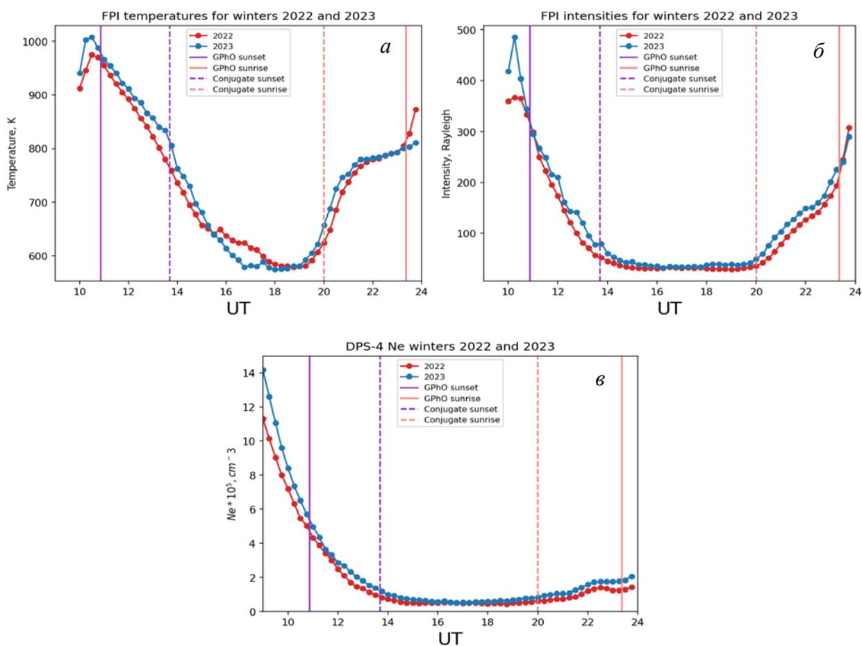
Рис. 1.2.2.2. Динамика интенсивности свечения красной линии атомарного кислорода 630 нм (а) и температуры нейтральной компоненты (б) зимой 2022–2023 и 2023–2024 гг.; динамика электронной концентрации в слое 200–300 км зимой 2022–2023 и 2023–2024 гг. (в)
