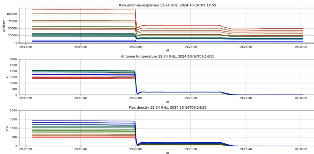
Рис. 1.1.3. Процесс абсолютной калибровки антенн СРГ диапазона 12–24 ГГц
