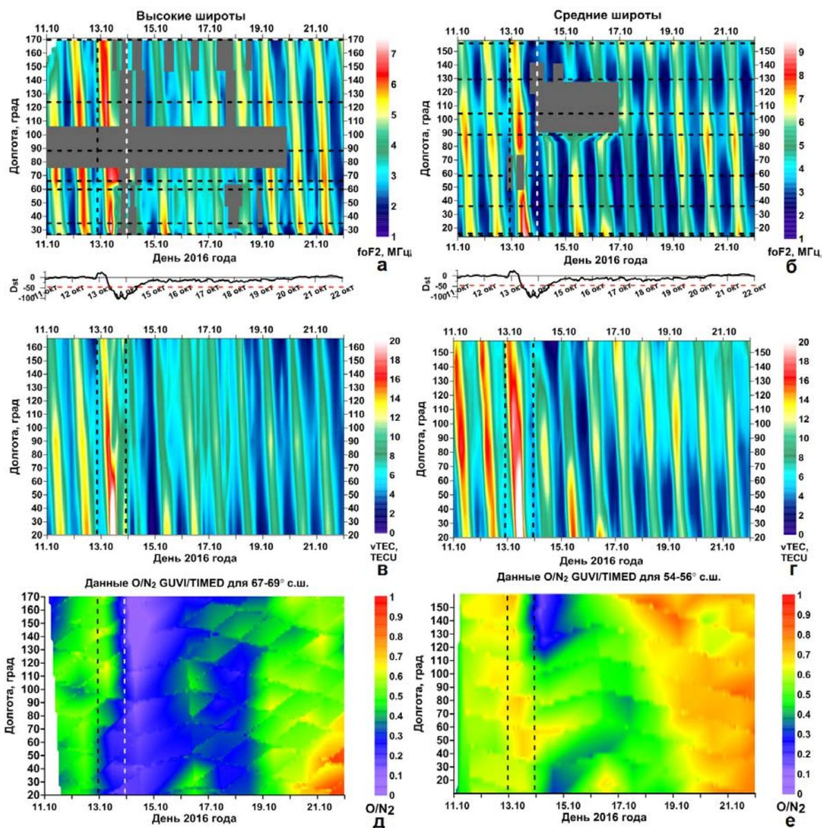
Рис. 2.2.2.7.1. Долготно-временные (UT) распределения  $f_oF2$  по данным высоко- (а) и среднеширотной (б) цепей ионозондов;  $vTEC$  по данным высоко- (в) и среднеширотной (г) цепей приемников GPS/ГЛОНАСС и  $[O]/[N_2]$  на высотах термосферы по измерениям GUVI TIMED над Евразией вдоль широтных полос  $69^{\circ}$ – $71^{\circ}$  N (д) и  $54^{\circ}$ – $56^{\circ}$  N (е); вертикальными штриховыми линиями показаны моменты начала бури и максимума магнитной бури
