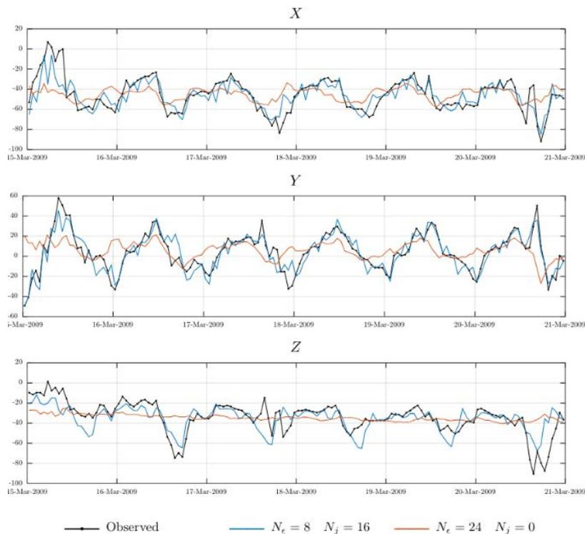
*Рис. 2.2.4.2.1.* Сравнение временных рядов, смоделированных и наблюдаемых в высокоширотной обсерватории Туле (ТНЛ), Гренландия, для шести спокойных дней 15–20 марта 2009 г. (сверху вниз): компоненты X, Y и Z
