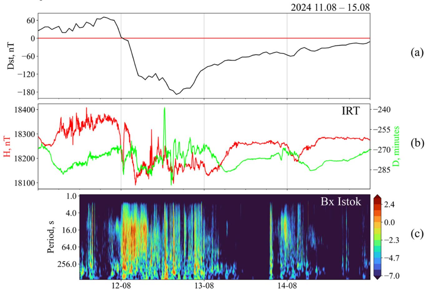
Рис. 3.7.1.2. Вариации  $Dst$ -индекса (a),  $H$ -компоненты и склонения  $D$  магнитного поля на ст. Патроны (b), а также вейвлет-спектрограмма геомагнитных пульсаций  $B_x$ -компоненты на ст. Исток (c) во время сильной магнитосферной бури 11–15 августа 2024 г.
