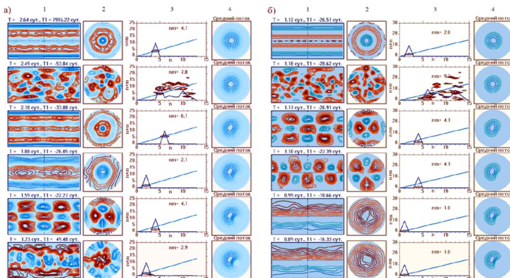
Рис. 2.2.4.6.1. Наиболее неустойчивые нормальные моды при разных конфигурациях среднего течения, для 13 (а) и 15 (б) гармоник в разложении полей при обычной турбулентной вязкости. Приведены (слева направо) функции тока нормальных мод в горизонтальной и полярных проекциях, спектры нормальных мод в координатах  $n$  (ось X) и  $n+m$  (ось Y) и распределения функции тока среднего течения в полярной проекции в относительных единицах
