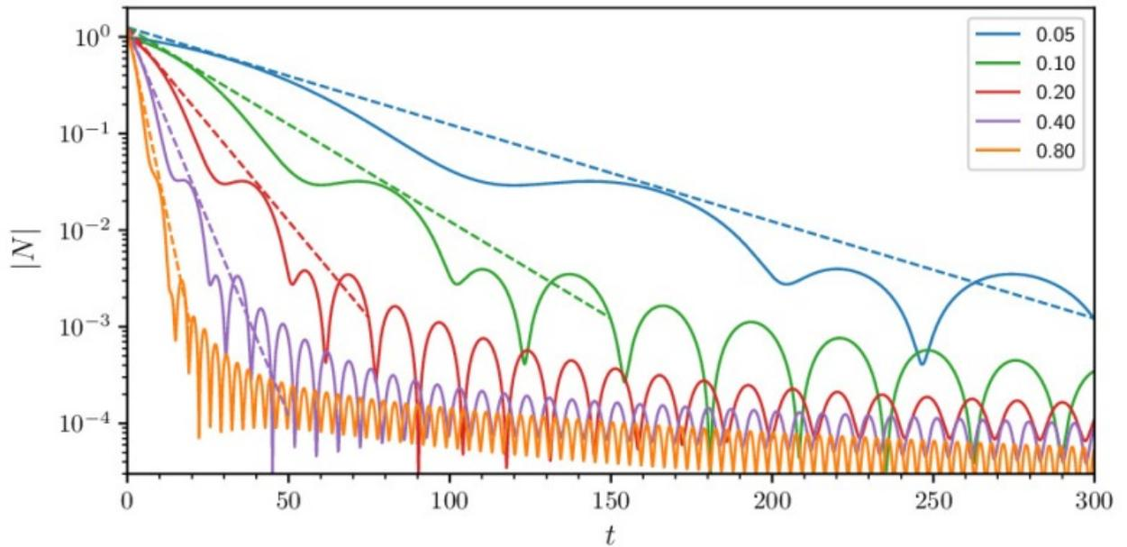
Рис. 2.2.5.18.1. Эволюция абсолютной величины полной завихренности поперек течения  $|N(t)| = |\int \zeta(y, t) dy|$  при различных значениях волнового числа  $k$  для начальной завихренности  $\zeta(y, 0)$  в форме гауссовской функции. Кривые для  $k = 0.4$  и  $k = 0.8$  соответствуют фазовой скорости, лежащей вне диапазона скоростей течения. Начальная стадия (штриховые линии) — экспоненциальное затухание (затухание Ландау), финальная стадия — степенное затухание
