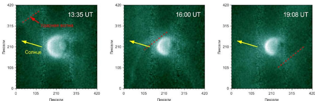
Рис. 2.2.5.16.1. Изображения с камеры IMAGE/EUV в 13:35, 16:00 и 19:08 UT 09.01.2005 г.: оттенки зеленого — яркость после коррекции плоского поля и сжатия динамического диапазона; красная штриховая линия — приблизительное положение ударной волны КВМ; жёлтая стрелка — направление на Солнце в плоскости изображения
