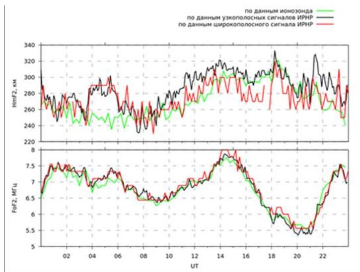
Рис. 2.2.1.5.1. Сравнение высоты максимума  $h_mF2$  и критической частоты  $f_oF2$ , полученных ионозондом (зеленые кривые), ИРНР с использованием узкополосного сигнала (черные) и ИРНР с использованием широкополосного сигнала (красные) для 05.06.2015
