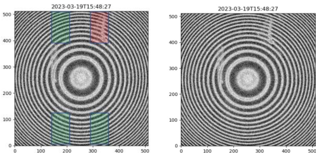
Рис. 2.2.4.13.1. Интерферограмма с видимыми изображениями звезд (слева), полученная на ИФП при экспозиции 120 с, а также интерферограмма с выделенными областями (справа) для подсчета отклика ИФП на звезду (красный прямоугольник) и для учета вклада колец (зеленые прямоугольники)
