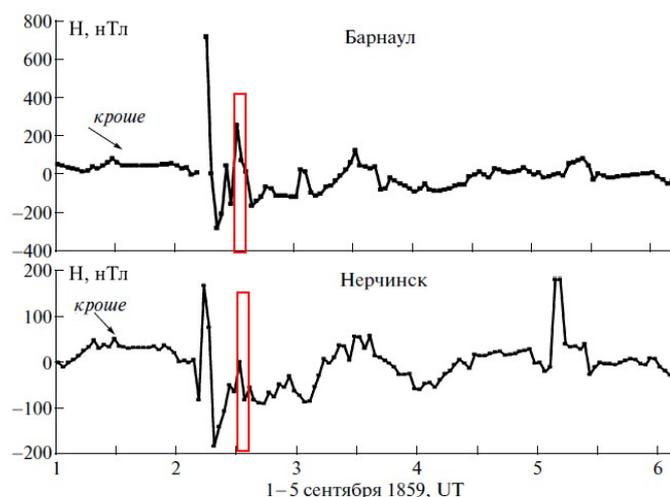
Рис. 2.2.4.14.1. Часовые значения отклонений от среднего  $H$ -компоненты магнитного поля 1–5 сентября 1859 г. для ст. «Барнаул» и «Нерчинск» и временной интервал наблюдения полярного сияния в Иркутске (выделен красным прямоугольником)
