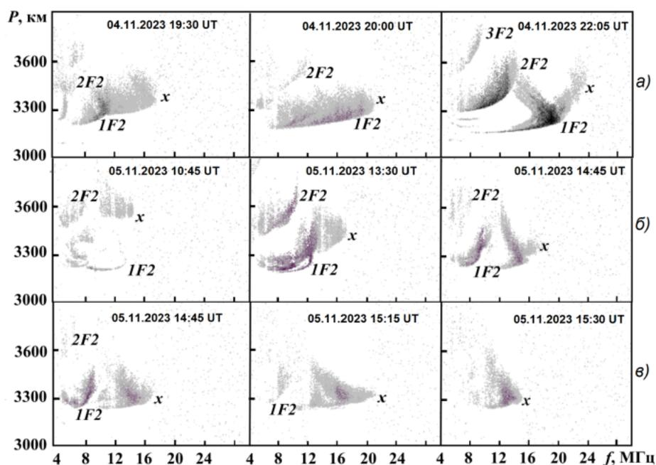
Рис. 2.2.2.2.2. Ионограммы наклонного зондирования на трассе Магадан – Иркутск (а–в) на главной фазе бури
