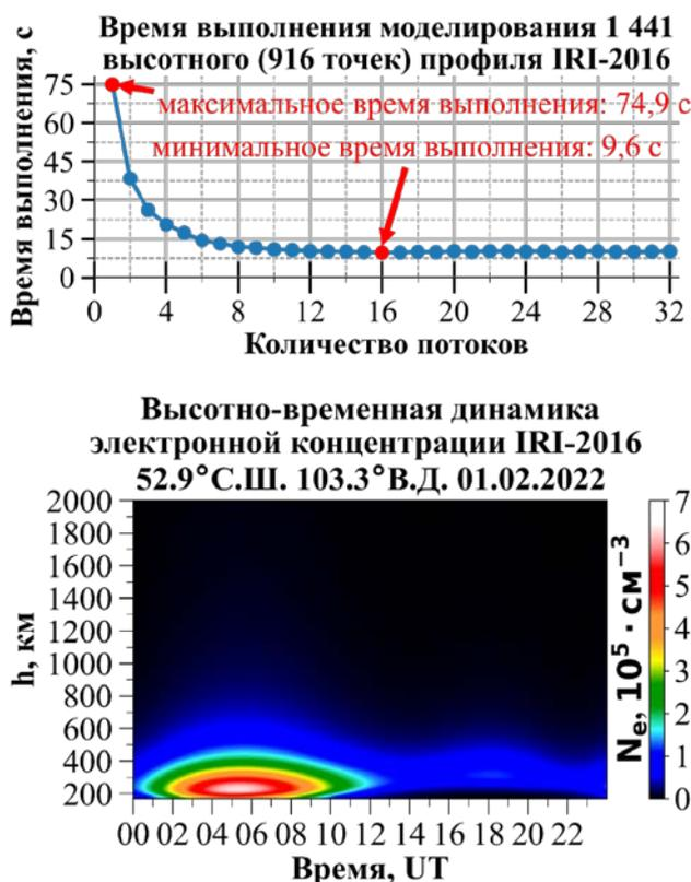
Рис. 2.2.1.3.1. Демонстрация прироста производительности IRI-2016 с использованием многопоточности (сверху) и результат моделирования (снизу)
