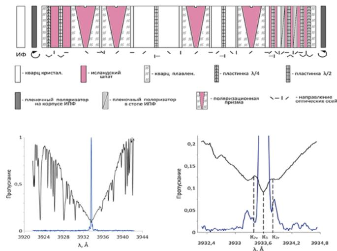
Рис. 2.3.1.1.1. Оптическая стопа ИПФ (вверху) и полоса пропускания ИПФ в двух масштабах (внизу)
