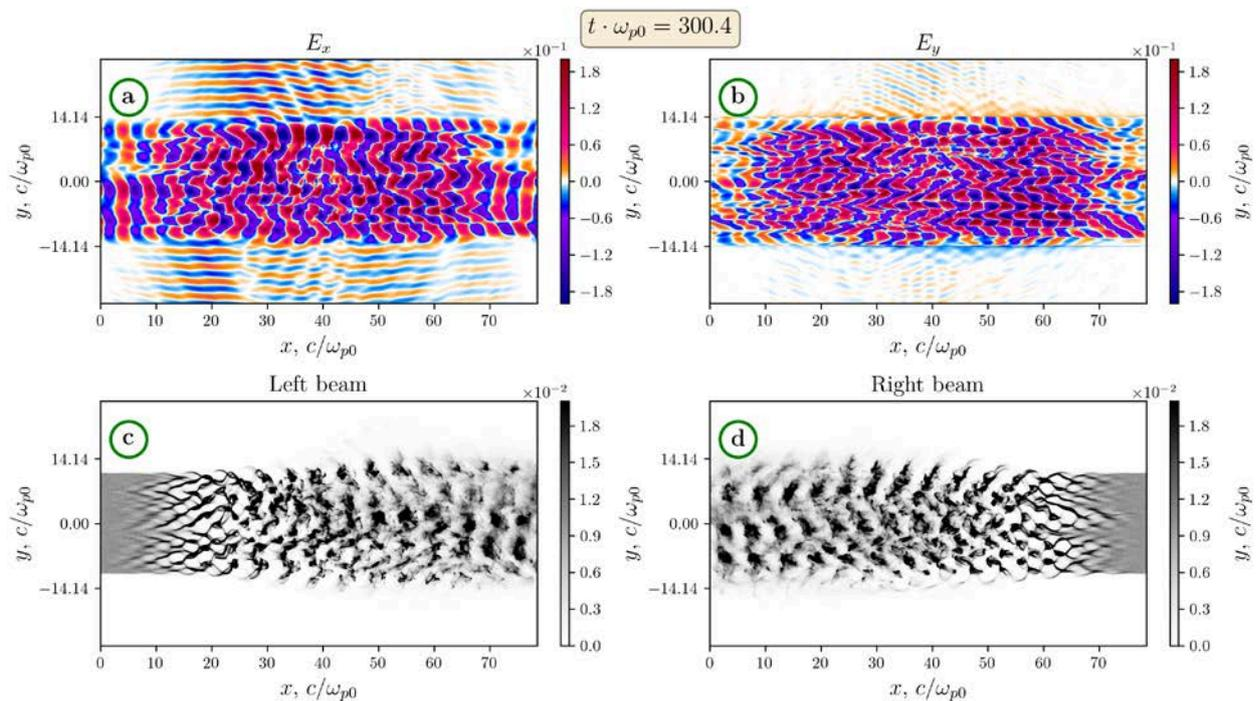
Рис. 2.2.6.4.1. Результаты 2D3V-моделирования методом частиц в ячейках генерации электромагнитного излучения при распространении в плазме двух электронных пучков в момент времени  $\sim 300\omega_p^{-1}$ . (a, b);  $E_x$  и  $E_y$  — электрические поля; плотности инжектируемых электронных пучков (c, d).
