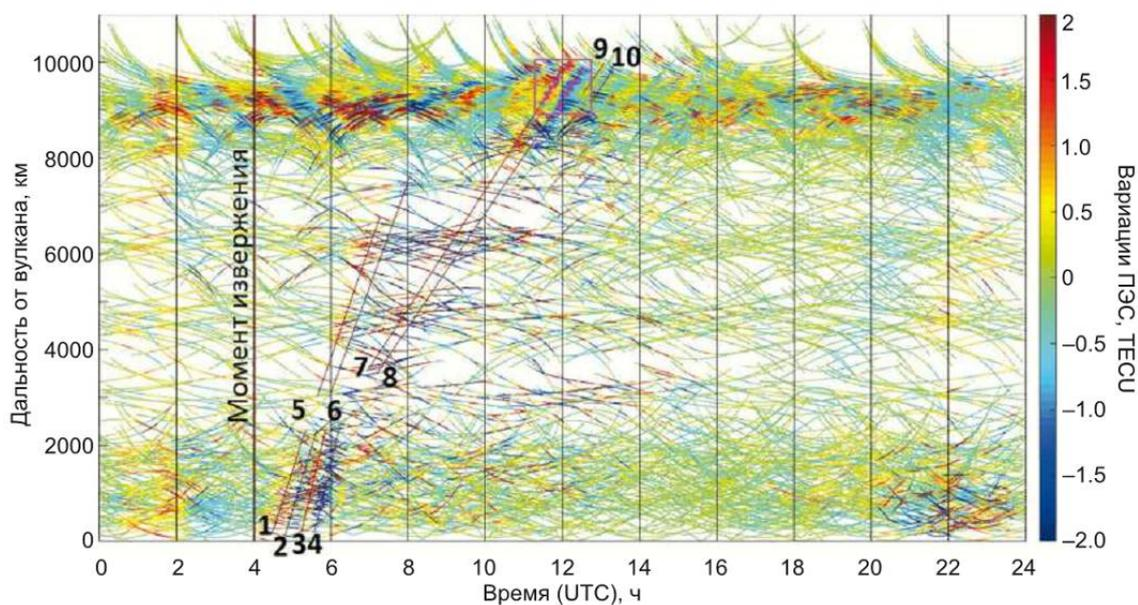
Рис. 2.2.3.7.1. Отфильтрованные в диапазоне 10–60 мин возмущения ПЭС, вызванные извержением вулкана Хунга-Тонга-Хунга-Хаапай 15 января 2022 г. Прямыми линиями и цифрами обозначены волновые фронты ионосферных возмущений, распространявшихся с разными скоростями
