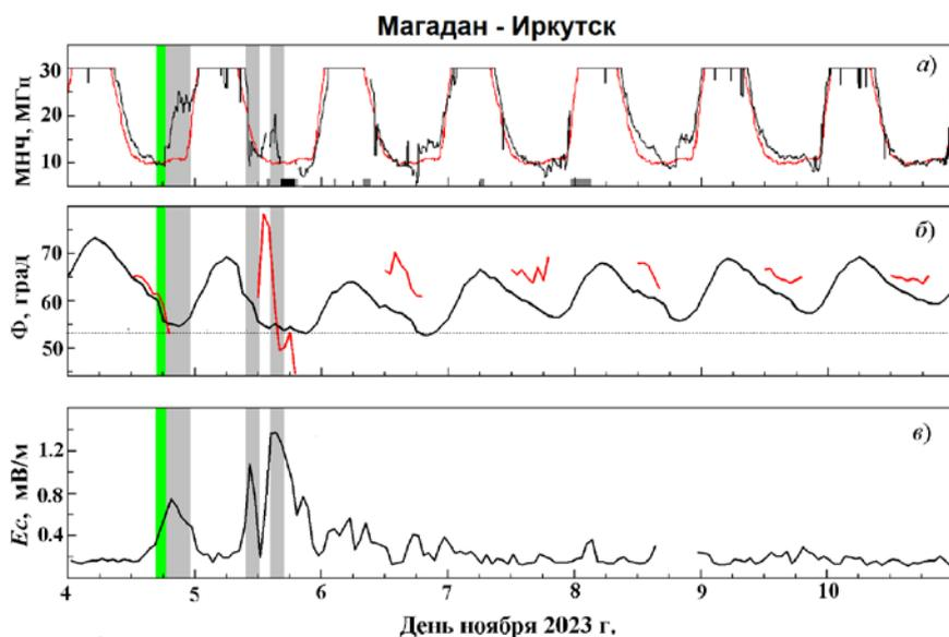
Рис. 2.2.2.2.1. Вариации МНЧ (а), инвариантных широт ГИП и ГДВ на меридиане 120° Е (б), напряженности электрического поля магнитосферной конвекции (в) для 4–10 ноября 2023 г.: зеленые прямоугольники — начало бури, серые — ступени главной фазы бури
