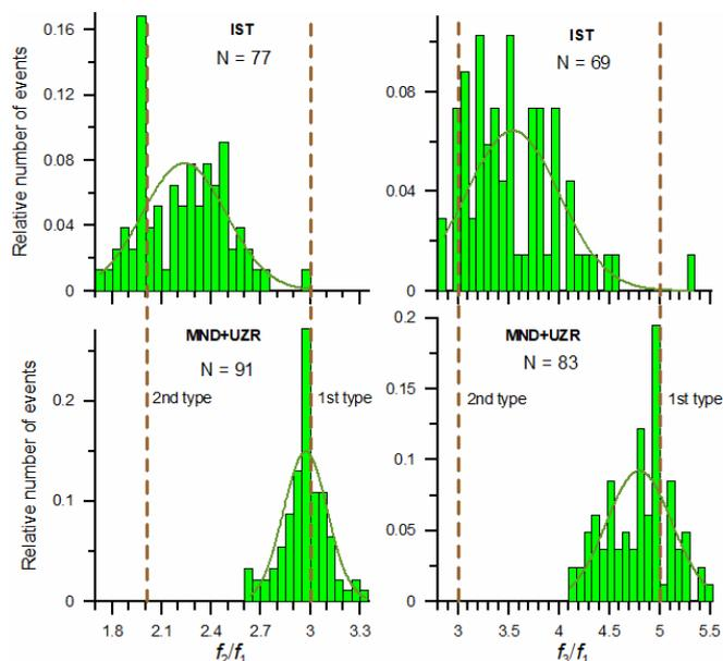
Рис. 2.2.5.8.1. Гистограммы распределений относительного числа событий по отношениям частот гармоник  $f_2/f_1$  и  $f_3/f_1$ : нижний ряд — на среднеширотных станциях MND и UZR; верхний ряд — на высокоширотной станции IST;  $N$  — число событий, на основе которых было построено распределение
