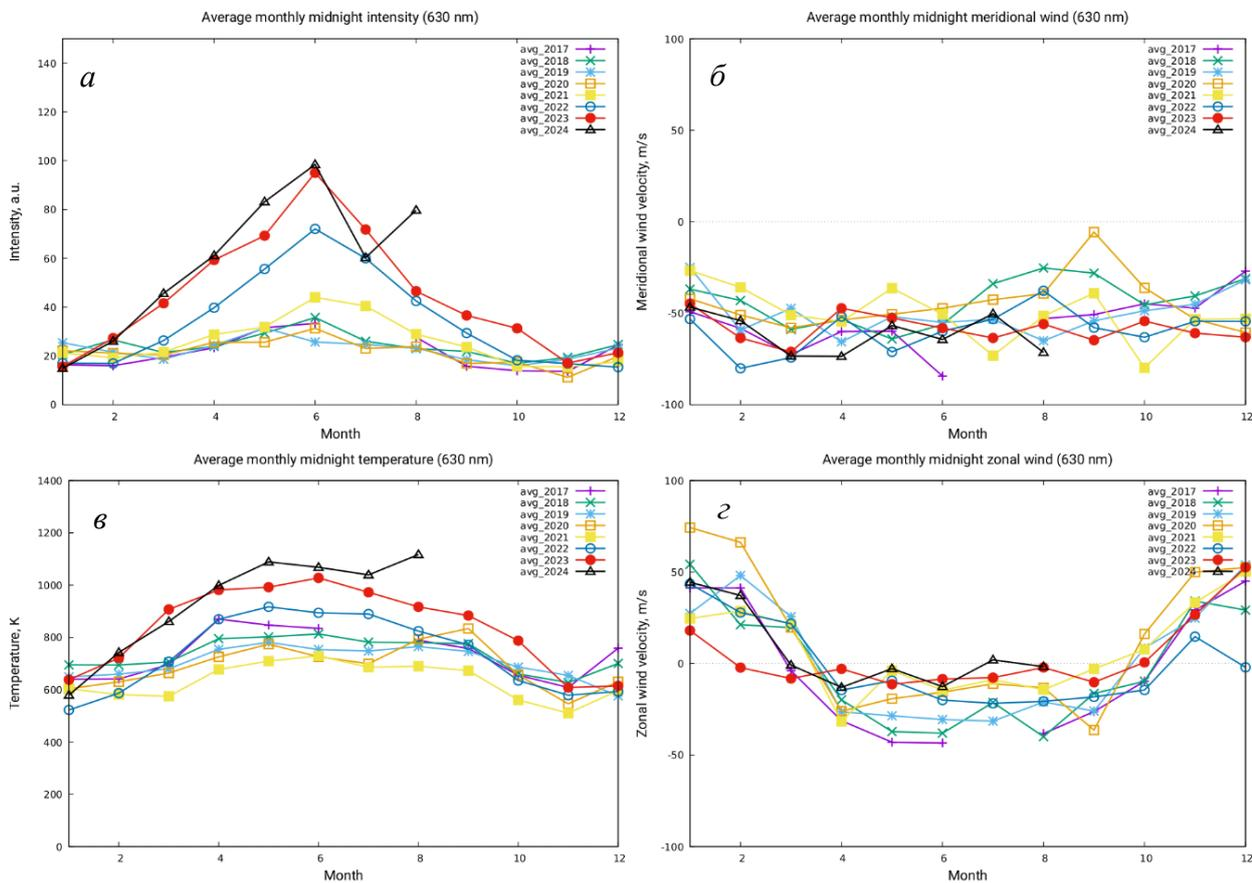
Рис. 1.2.1.2. Среднемесячные значения полуночных интенсивности свечения (а), скорости меридионального ветра (б), температуры (в) и скорости зонального ветра (г) по годам наблюдения
