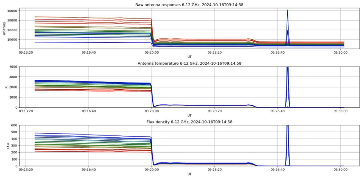
Рис. 1.1.2. Процесс абсолютной калибровки антенн СРГ диапазона 6–12 ГГц
