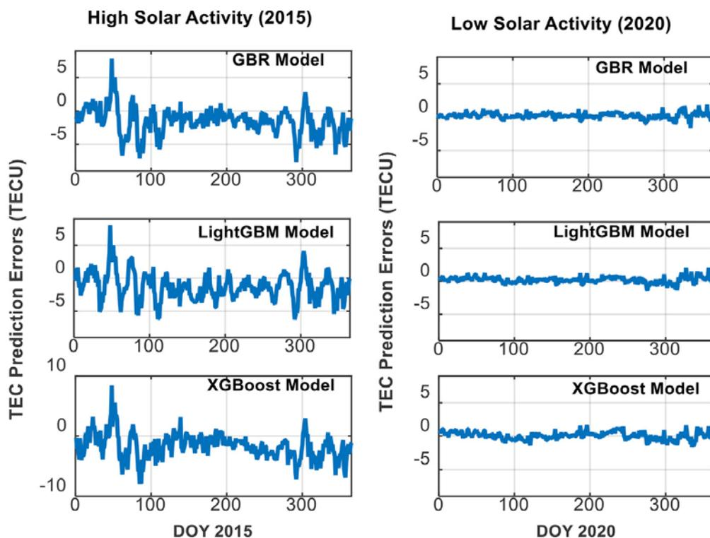
Рис. 2.2.6.6.1. Погрешности прогнозирования ПЭС во время высокой (2015 г.) и низкой (2020 г.) солнечной активности на основе моделей GBR, lightGBM и XGBoost
