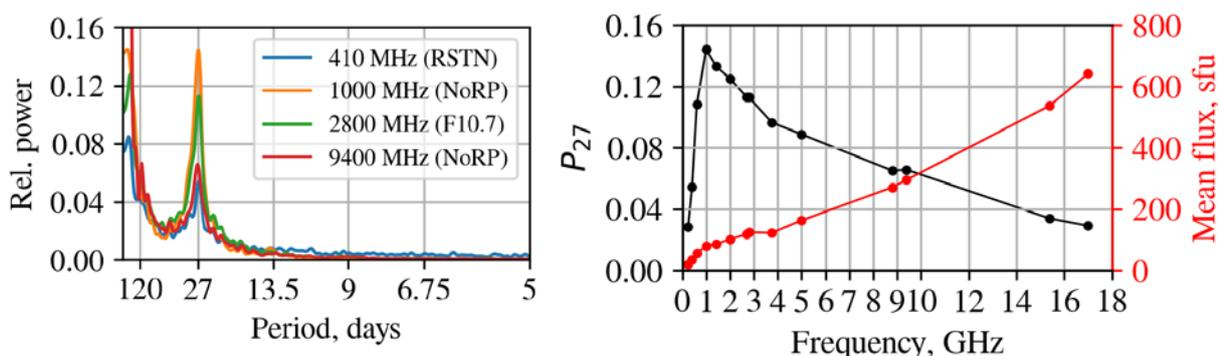
Рис. 2.2.1.2.1. Средние спектры Ломба — Скаргла для солнечного радиоизлучения (слева); справа — частотные зависимости нормированной мощности 27-дневной компоненты (черная кривая) и среднего значения потока (красная)
