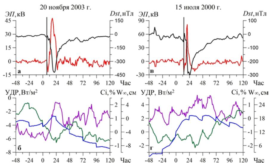
Рис. 2.2.3.1.1. Аномалии ЭП (красная линия),  $Dst$ -индекса (черная линия) (а, в) и метеопараметров (б, г): УДР (зеленая линия), облачность верхнего яруса ( $Ci$ , фиолетовая линия), осажденная вода ( $W_{\infty} \times 10^{-2}$ , синяя линия) за 7-дневный интервал во время геомагнитных бурь 20 ноября 2003 г. и 15 июля 2000 г. Вертикальная линия — начало геомагнитной бури. Ноль по горизонтальной оси соответствует 00:00 UT дня начала геомагнитной бури
