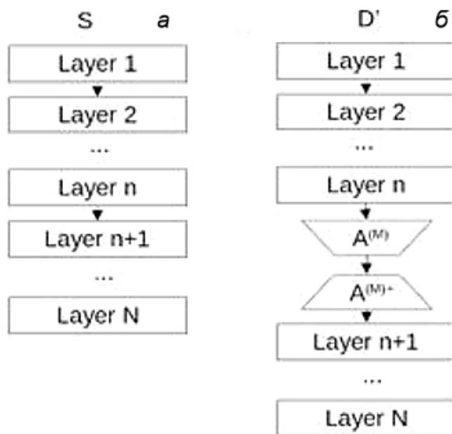
Рис. 2.2.1.8.1. Архитектура проверяемой нейронной сети (а) и способ поиска минимального числа нейронов в слое n (б)
