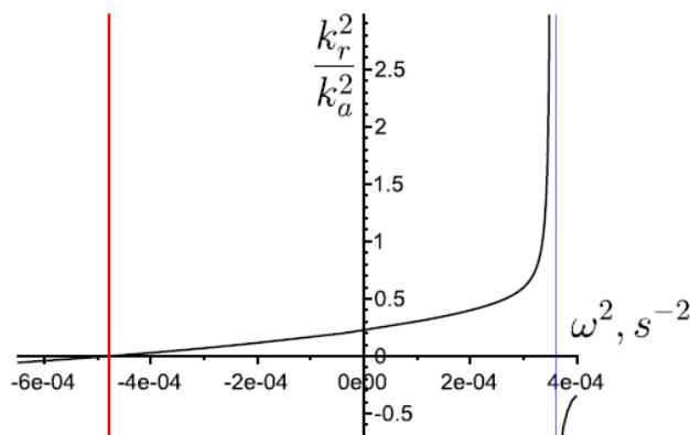
Рис. 2.2.5.2.1. Зависимость отношения радиальной и азимутальной компонент волнового вектора от квадрата частоты для медленного магнитного звука в дипольной модели магнитосферы
