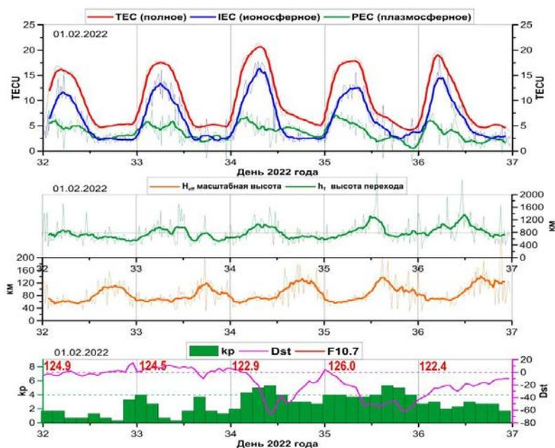
Рис. 2.2.3.6.1. Динамика электронного содержания плазмосферы и ионосферы (верхняя панель), а также высоты  $h_T$  перехода  $O^+/H^+$  и масштабной высоты  $H_{\text{eff}}$  1–5 февраля 2022 г.
