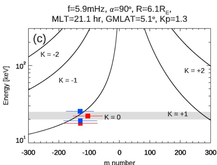
Рис. 2.2.5.1.1. Зависимость резонансной энергии от азимутального волнового числа  $m$  для различных гармоник  $K$  баунс-дрейфового резонанса. Цветные прямоугольники соответствуют наблюдавшимся значениям
