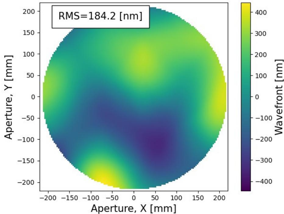
Рис. 3.1.2. Результат определения СКО волнового фронта на длине волны 433 нм, полученный с помощью датчика Шака — Гартмана по наблюдениям на БСВТ
