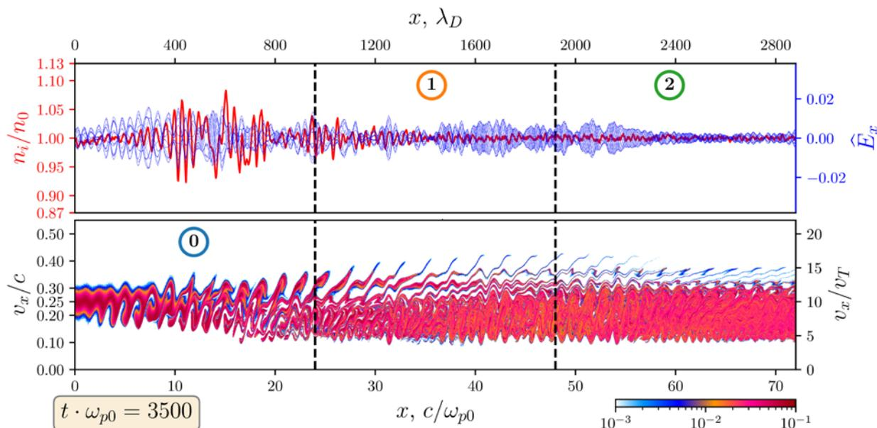
Рис. 2.2.6.5.1. Результаты моделирования инъекции пучка в плазму. Вверху — плотность ионов (красная линия), различные фазы одного колебания плазмы (синие линии); внизу — фазовое пространство  $f(v_x, x)$  пучка.
