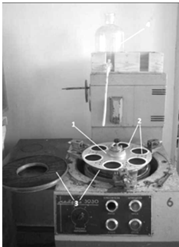
Рис. 167. Станок для двусторонней оптической обработки: 1 — сепаратор, 2 — окна для деталей, 3 — планшайбы, 4 — подача суспензии
