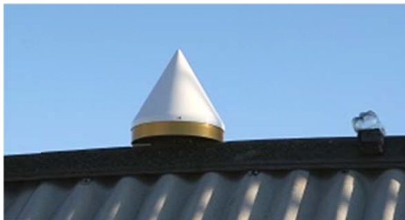
Рис. 146. Приемник сигналов с навигационных спутников GPS/GLONAS для определения ПЭС в ионосфере и магнитосфере
