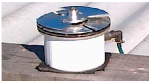
Рис. 147. Электростатический флюксметр для измерения вертикального градиента потенциала электрического поля атмосферы
