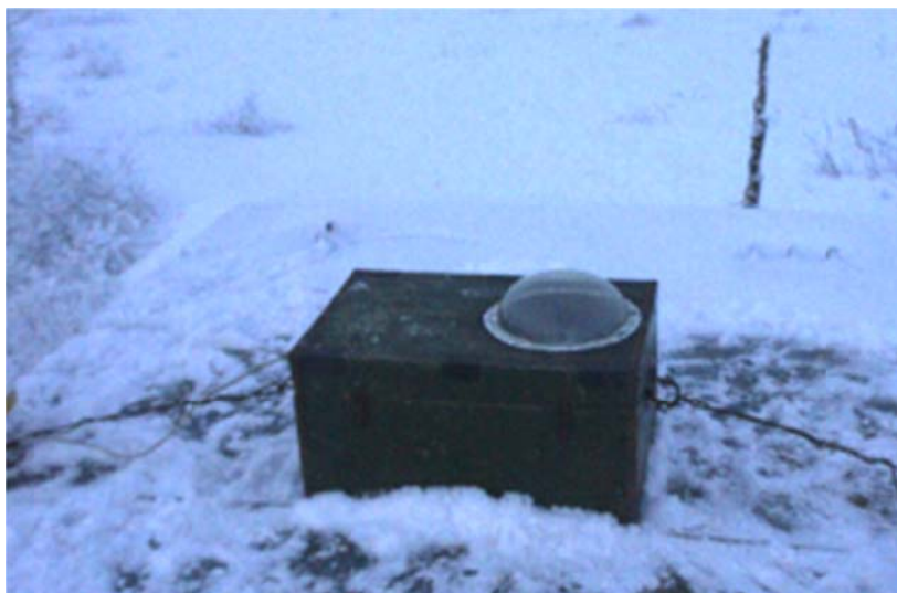
Рис. 137. Термоизолированный кожух для оборудования, установленный на крыше контрольно-измерительного пункта
