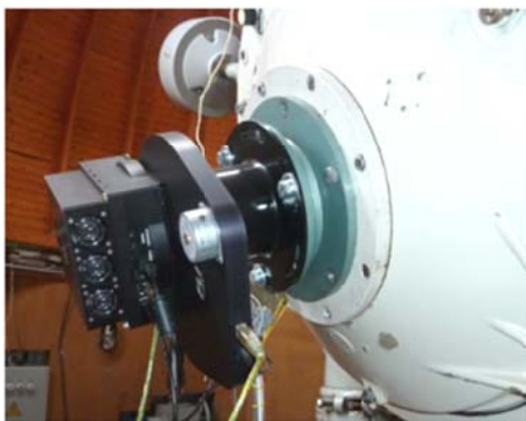
Рис. 196. Система регистрации, установленная в фокусе телескопа Цейсс-600
