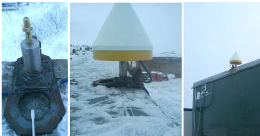
Рис. 120. Элементы крепежа антенны и ее общий вид после установки
