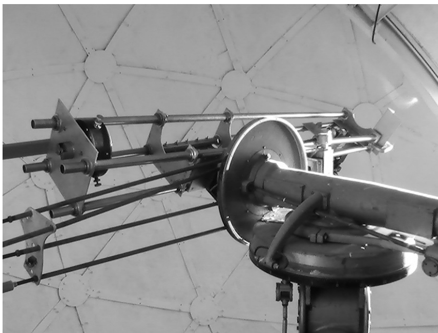
Рис. 56. Ферма коронографа со сферическим главным зеркалом 180/130 мм после установки на монтажку АПШ-6.
