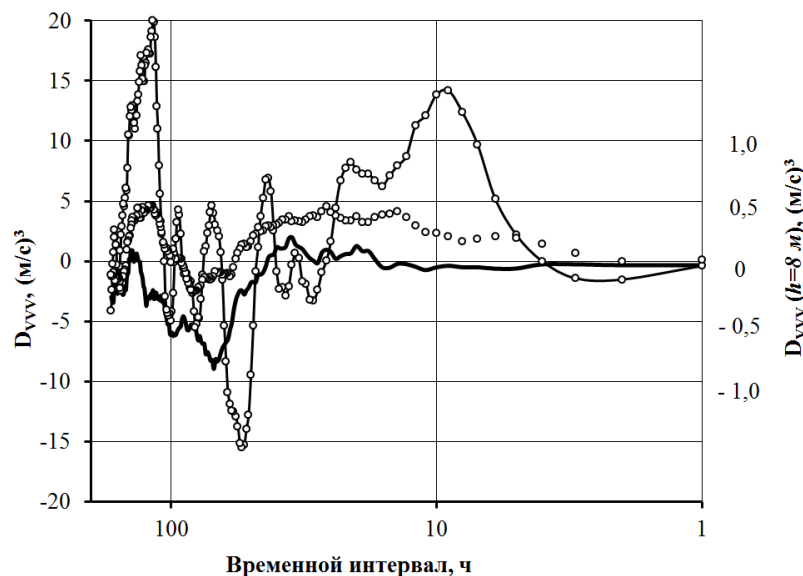
Рис. 20 – Структурные функции третьего порядка для скорости ветра Жирная непрерывная линия – 8 м, маркеры круглой формы – 121 м, непрерывная линия с маркерами круглой формы – 301 м.
