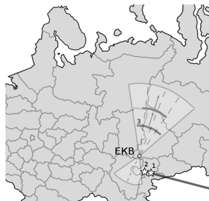
Рис. 1. Геометрия эксперимента. Черная линия – траектория метеорита, 1 – место взрыва метеорита, 2 – место предполагаемого падения, 3 – восстановленный фронт неоднородности. Секторами обозначены зоны сканирования радара главным и задним лепестками ДН.
