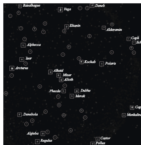
Рисунок 1 - Пример работы алгоритма идентификации звезд. Показана часть кадра оптической системы КЕО Sentinel, зарегистрированного 3 декабря 2016 г. Кругом обозначены области кадра, идентифицированные как звезды, квадратом - совпавшие со звездным каталогом.
